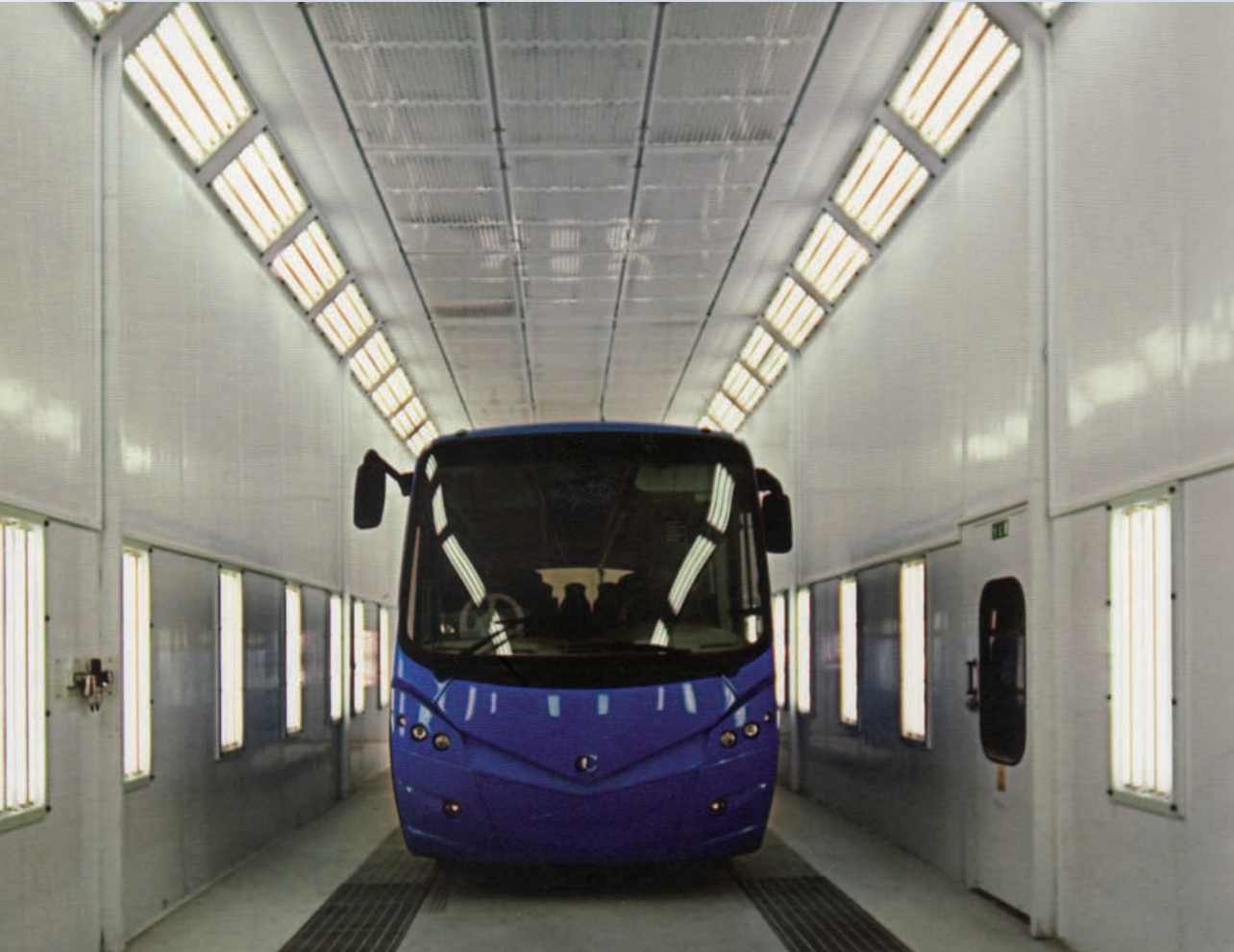
Καμπίνα βαφής μεγάλων οχημάτων (πούλμαν, λεωφορείων, τρακτόρων) με ηλεκτρικό άνοιγμα πόρτας.
